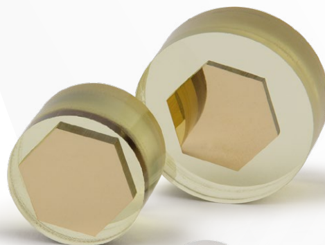
Échantillons enrobés après polissage
